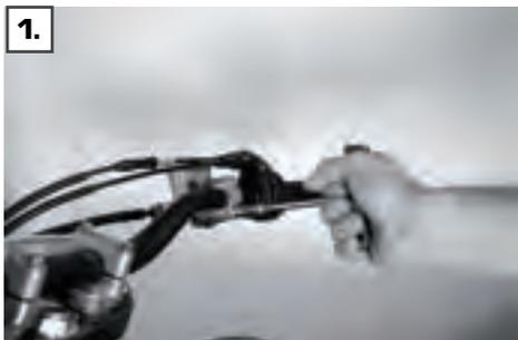
1. Bremspumpe demontieren
