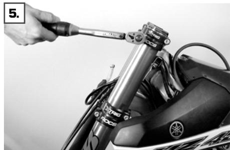
5. Insérez la fourche, y compris la roue avant et le système de freinage, dans la pince triple.
