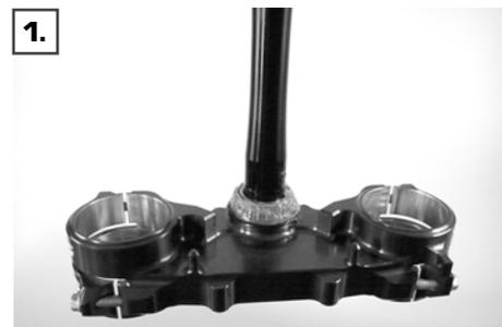
1. Graissez le roulement de la tête de direction de la pince triple XTRIG prémontée avec une graisse pour roulements appropriée.
