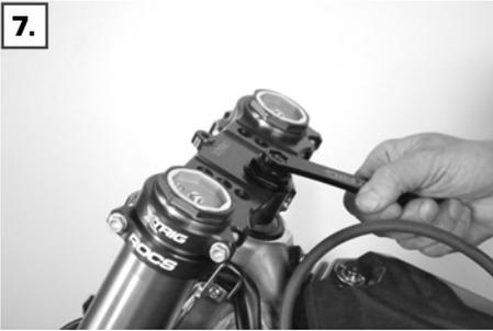
Visser la vis de blocage (5) dans l'écrou de réglage (4) et serrer avec 10 Nm.
