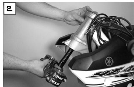
2. Poussez le collier triple inférieur dans la tête de direction tout en maintenant le roulement supérieur de la tête de direction et la rondelle d'étanchéité contre lui.
