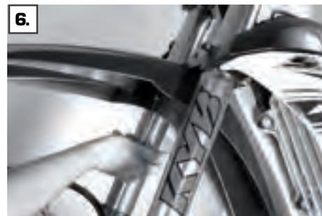
6. Kotflügel demontieren
