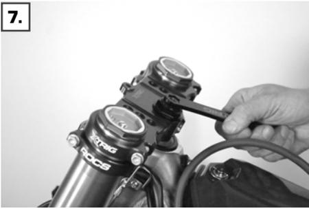
Die Sicherungsschraube (5) in die Einstellmutter (4) einschrauben und mit 10 Nm anziehen.
