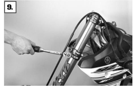
Serrez les vis M8x40 (9) de l'étrier triple inférieur avec 15 Nm. Remontez le garde-boue avant et le guide de la conduite de frein.
