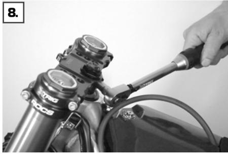
Schraube M8x25 (8) zur Klemmung des Schaftrohres mit 20 Nm anziehen.
