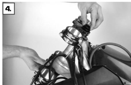
4. Mettez le pont supérieur du ventilateur et serrez l'écrou de réglage (4) à la main.
