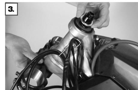
3. Montez maintenant le joint du palier de la tête de direction (bague d'étanchéité ou joint torique), selon le modèle.
