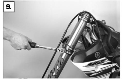
Die Schrauben M8x40 (9) der unteren Gabelbrücke mit 15 Nm anziehen. Kotflügel vorne und Bremsleitungsführung wieder montieren.
