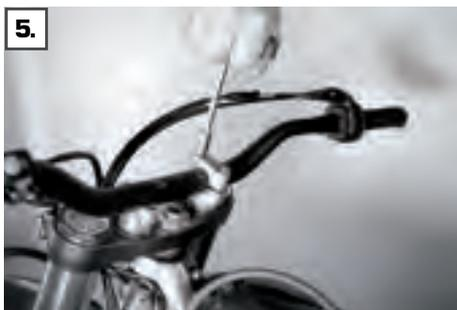
5. Lenker und eventuelle Befestigungen wie Kabelbinder demontieren
