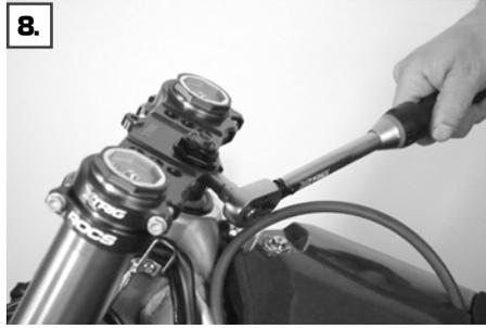
Serrer la vis M8x25 (8) pour le serrage du tube de l'arbre avec 20 Nm.
