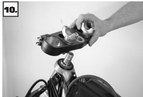
10. Déposer le triple collier de serrage supérieur
