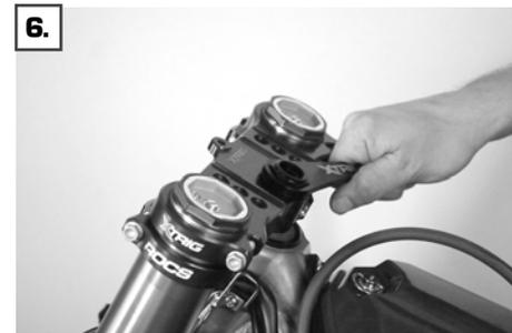
6. Réglez le jeu de roulement requis à l'aide de l'écrou de réglage (4).
