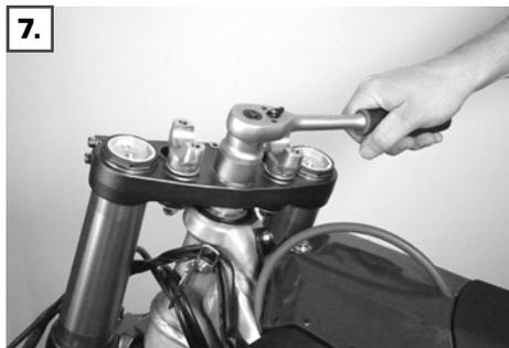
Befestigungsmutter der oberen Gabelbrücke lösen
