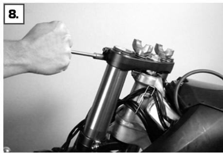
Klemmungen der oberen und unteren Gabelbrücke lösen
