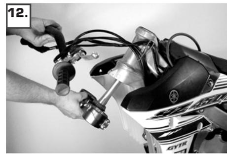
12. Démontez l'étrier triple inférieur, nettoyez la tête de direction et le siège du roulement de la moto.
