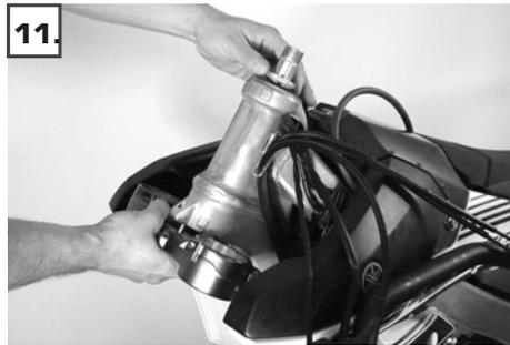
11. Maintenez l'étrier triple inférieur et retirez l'écrou de réglage du roulement de la tête de direction.
