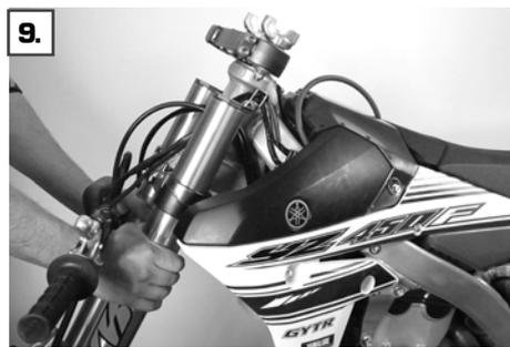
9. Retirez la fourche avec la roue avant et le système de freinage vers le bas
