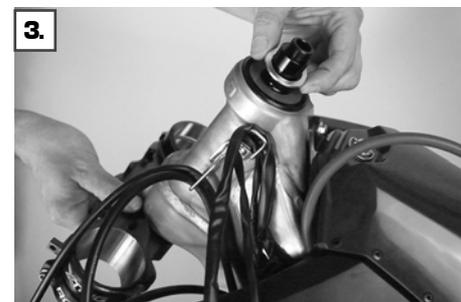
Nun modellabhängig die Abdichtung für das Lenkkopflager montieren (Dichtring oder O-Ring)
