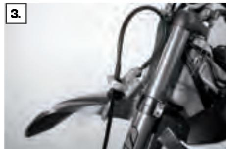
3. Bremspumpe an Bremsleitung montieren
