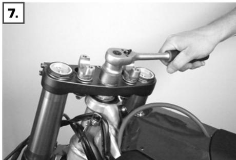
7. Desserrer l'écrou de fixation de l'étrier triple supérieur
