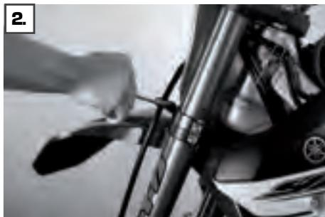
2. Bremsleitungsführung demontieren
