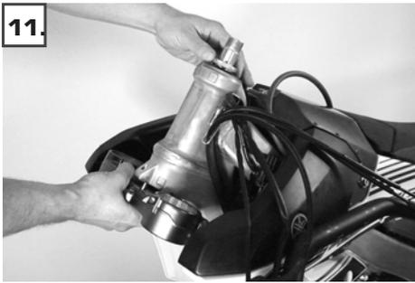
Untere Gabelbrücke festhalten und die Einstellmutter des Lenkkopflagers demontieren
