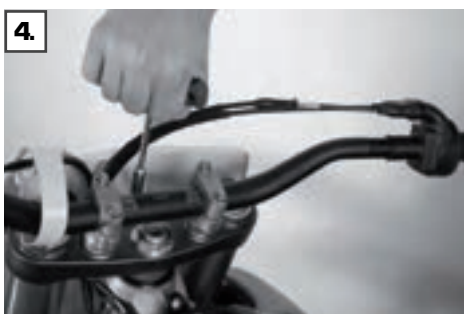
4. Démontez la plaque de démarrage selon le modèle
