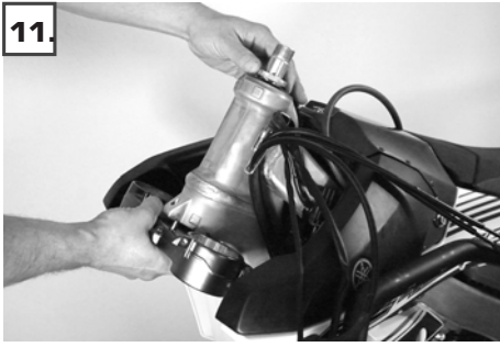
Untere Gabelbrücke festhalten und die Einstellmutter des Lenkkopflagers demontieren
