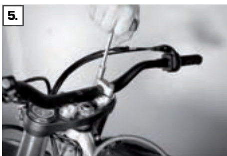
5. Démontez le guidon et toutes les fixations telles que les serre-câbles.
