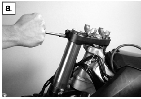
Klemmungen der oberen und unteren Gabelbrücke lösen
