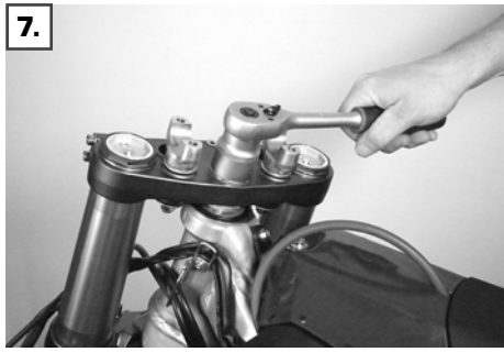
Befestigungsmutter der oberen Gabelbrücke lösen
