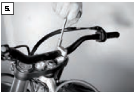
5. Lenker und eventuelle Befestigungen wie Kabelbinder demontieren
