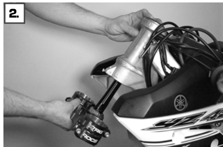
Die untere Gabelbrücke in den Lenkkopf einschieben, dabei das obere Lenkkopflager und die Dichtscheibe gehalten
