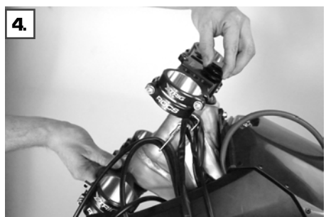
Obere Gabelbrücke aufsetzen und die Einstellmutter (4) mit Hand andrehen.
