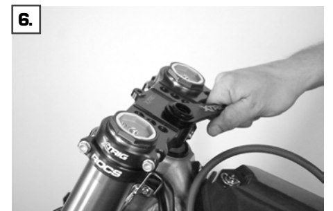
Das gewünschte Lagerspiel mit der Einstellmutter (4) einstellen
