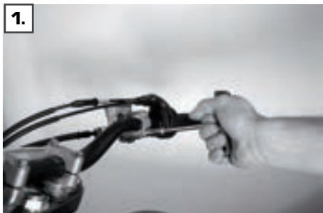
1. Démontage de la pompe à frein
