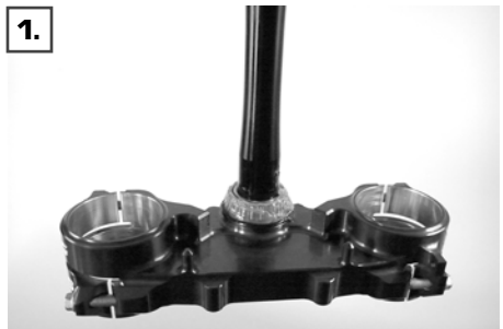
Das Lenkkopflager der vormontierten XTRIG Gabelbrücke mit geeignetem Lagerfett einfetten
