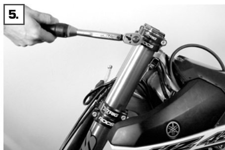
Gabel samt Vorderrad und Bremsanlage in die Gabelbrücke einsetzen.
