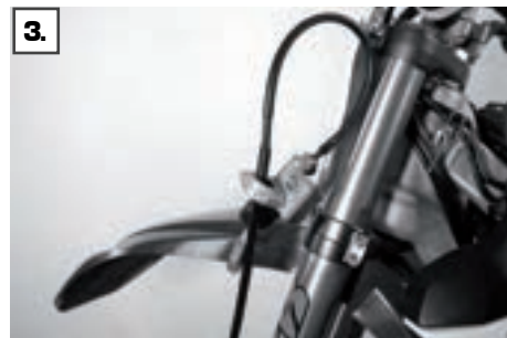
3. Installation de la pompe à frein sur la conduite de frein
