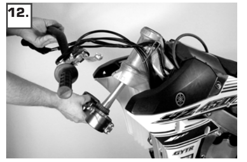
Untere Gabelbrücke demontieren, den Lenkkopf und den Lagersitz des Motorrads reinigen
